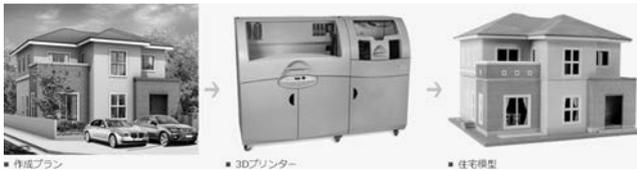
図1 3次元CAD図面から3Dプリンターを用いて住宅模型を作製するサービスの模式図
