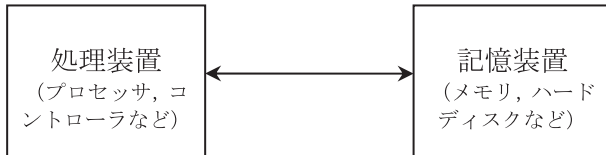
図1：コンピュータの単純化したアーキテクチャ
