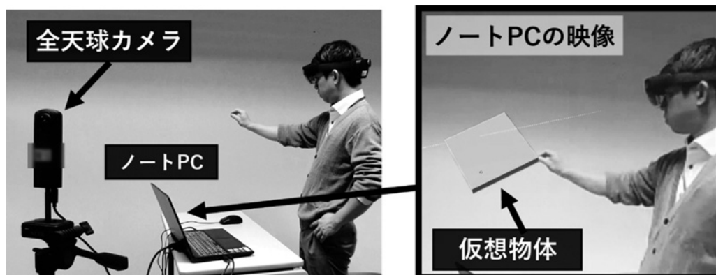
図3 リアルタイム拡張仮想テクノロジーを使用する際の機材構成
