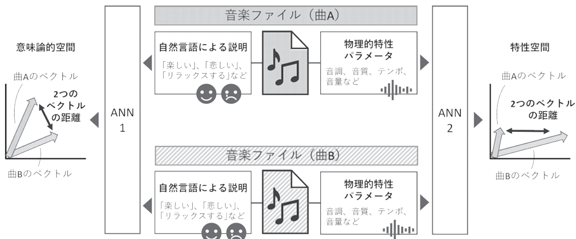
図1 本件出願発明における2点の音楽ファイルの比較のイメージ図
